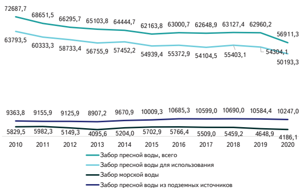
Рисунок 4.42 – Динамика показателей различных видов забора воды из водных объектов Российской Федерации, 2010–2020 гг., млн м 3
