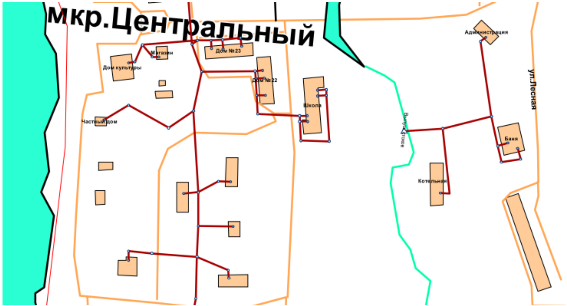
Рис.19 Водоотведение Иссадского сельского поселения (мкр. Центральный, ул. Лесная).
