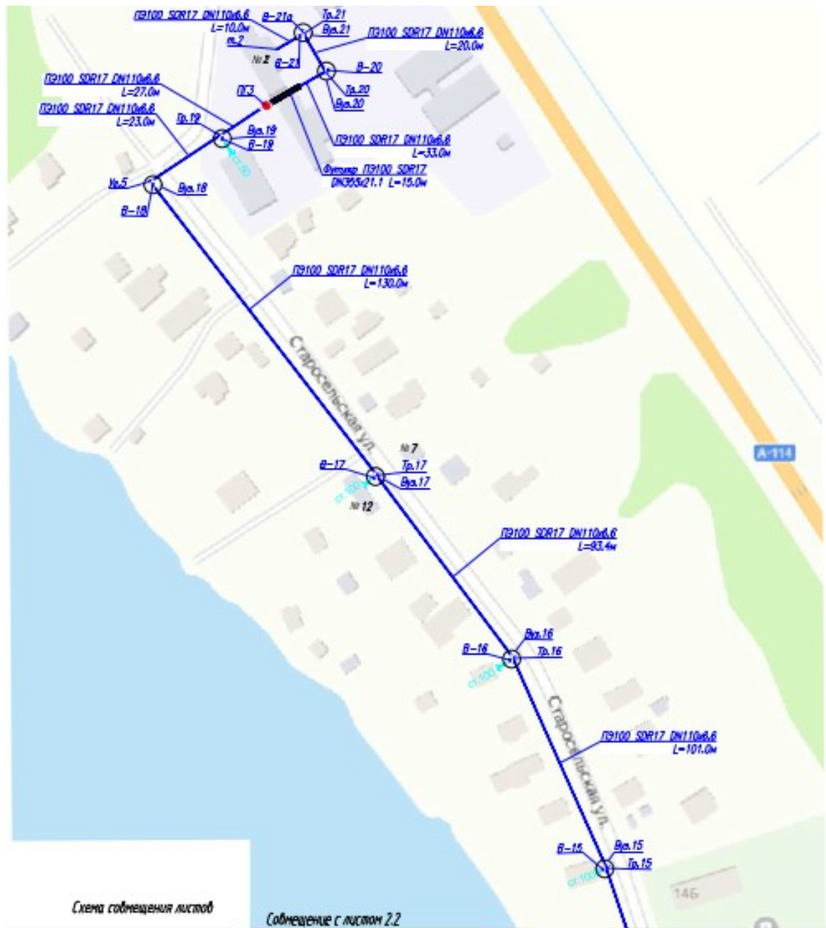
Рисунок 8. Капитальный ремонт водопроводной сети д. Иссад
